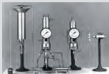
Experimentálny prístroj Malé zariadenie, veľký účinok: prístroj Fritza Habera (na obrázku jeho replika) sa stáva pre spoločnosť BASF základom syntézy amoniaku v malom meradle.
